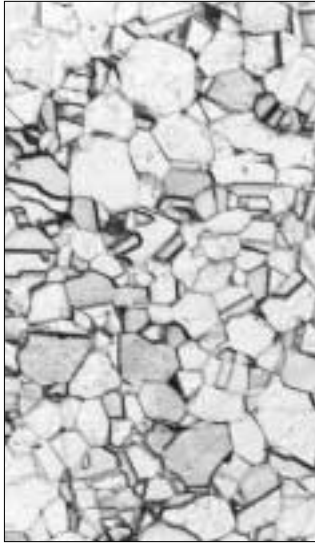
Figuur 6.4 Austeniet, AISI 304, (roestvast staal), 250 x
