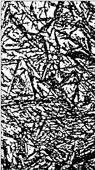
Figuur 6.7 Grove martensiet, AISI 1060, 600 x
